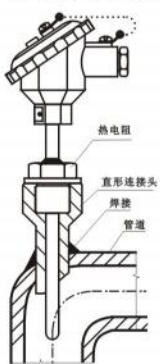
倾斜管道安装方法
