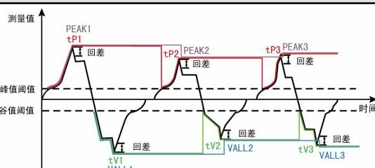
1. 如上图所示，当测量值超过“峰值阈值”后，仪表开始检测峰值；当测量值回落幅度超过“峰值回差”（图中 B1=PEAK1—“峰值回差”）后，仪表完成峰值检测。获取到峰值 PEAK1。
