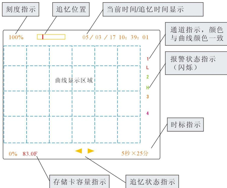
按◀或▶键可以改变实时曲线显示的时标。按◀键, 时标朝着更快的方向移动。到最快的时标后, 再按◀键不起作用。按▶键时标朝着更慢的方向移动。到最慢的时标后, 再按▶键不起作用。
