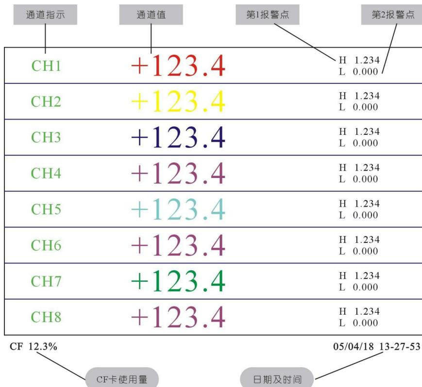
在数字显示画面上显示各通道的测量值，工程量单位，第一报警设定值，第二报警设定值。左下角为存贮卡记录容量。右下脚为当前的日期及时间。
