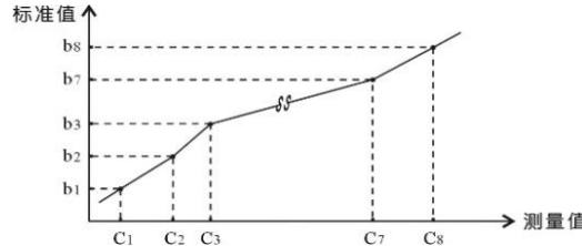
★ 小于  $C_1$  的测量值, 仪表按后一段的数据向下递推; 大于  $C_8$  的测量值, 仪表按前一段的数据向上递推。
