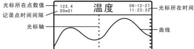
图中记录点时间间隔 00m01，其中 00 表示记录间隔分，01 表示记录间隔秒。瞬时量历史曲线画面包含温度、压力、流量三个画面，按查询键可依次切换。按上、下键可以向前后翻页，按左、右键可以在一个页面内左右移动光标轴。
