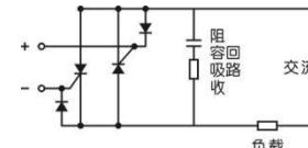
可控硅触发输出接双向可控硅
