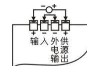
(6) 仪表与 3 线制、4 线制电压、电流变送器的接线
