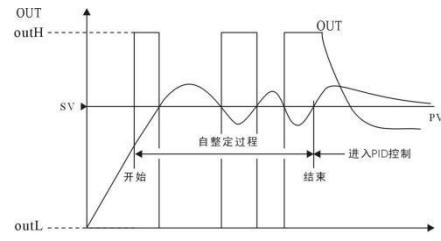
设置为 OFF 时，自整定停止/关闭，面板上 AT 指示灯灭。
