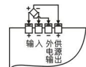
(5) 仪表与 2 线制变送器电流信号的接线
